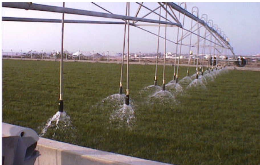
Vista parcial del tratamiento terciario por infiltración - percolación de Torre Vieja (Alicante)
